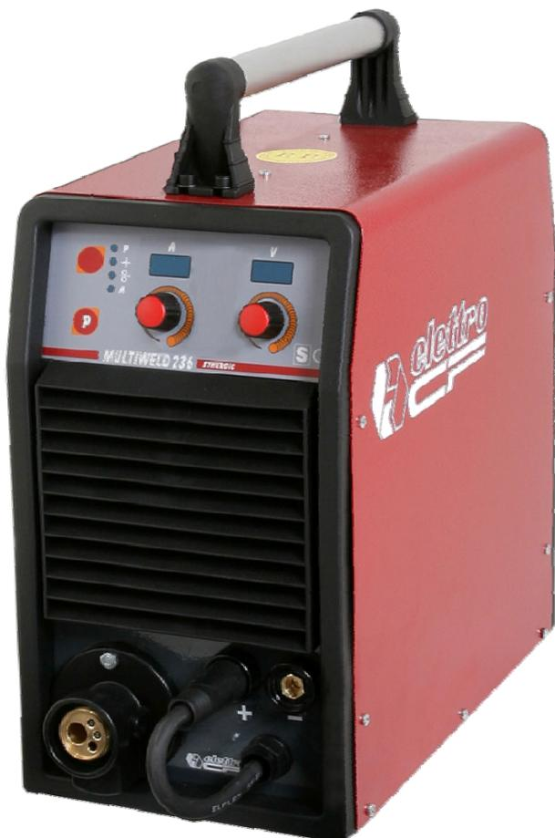
Generatore **inverter monofase multifunzione** in grado di saldare **alternativamente in MIG/MAG, MMA e TIG DC (con innescio lift)**. E' **compatto e leggero** e, con una **corrente di saldatura di 220A**, offre la possibilità di saldare fili di diametro fino a 1,2 mm. Può essere **alimentato da motogeneratori** di potenza adeguata.
