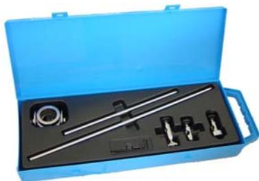
309462 - Kit compasso a carrello. Agevola il taglio di cerchi regolari e precisi, può essere utilizzato come guida altezza torcia e nelle applicazioni di taglio rettilineo e inclinato.
