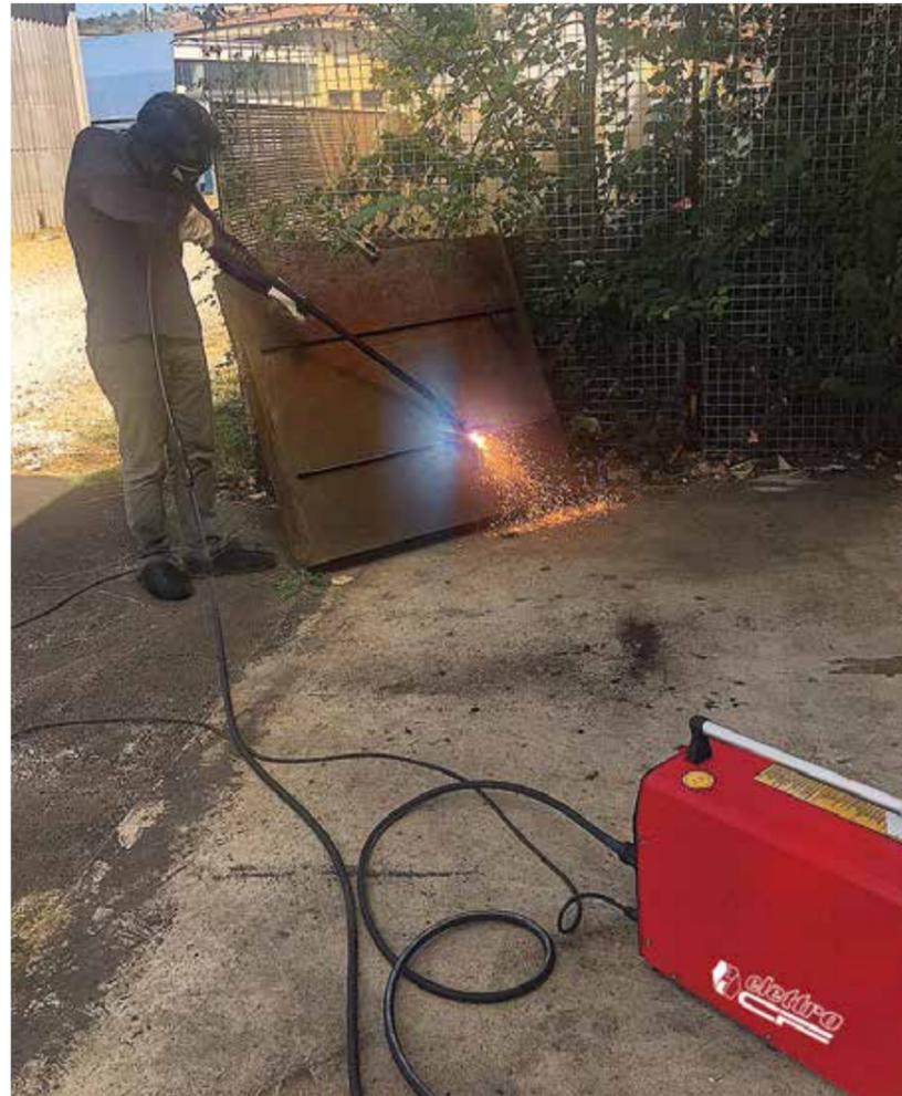
Die langen Schneidbrenner ECF-131 und ECF-181 ermöglichen, schwer erreichbare Teile sicherer, schneller und bequemer zu schneiden.
