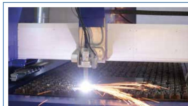
**AUTOMATISCHER BETRIEB:** empfohlener Strom von 150 A, um das Leistungs- / Lebensdauerverhältnis der Verschleißteile zu maximalisieren, bis zu höchstens 165 A entsprechend einer Einschaltdauer von 100%.
