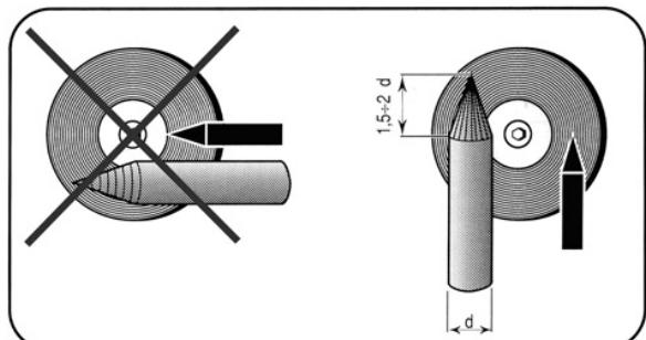
Die Elektrode leicht anschleifen, so dass sie vertikale Riefen aufweist (siehe die Abbildung).
