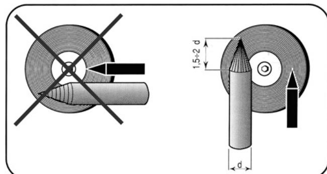
Esmerilar la punta del electrodo de forma que presente una estría vertical como se indica en la figura.
