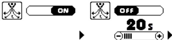
Der werkseitig eingestellte Standardmodus ist AUTO ON, sodass der Generator die Dauer des Nach-Gases je nach dem eingesetzten Schneidbrenner, dem eingestellten Stromwert und dem gewählten Bearbeitungsprozess automatisch und synergetisch regeln kann. Diese Funktion kann jedenfalls auch auf OFF geschaltet werden, um die Dauer des Nach-Gases von Hand zu regulieren.
