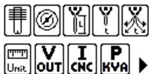
Alle aktivierte automatischen oder optionalen Einstellungen bleiben hervorgehoben, bis ihre Funktionsweise geändert wird. Um das Menü zu verlassen, muss nicht gewählt werden, einfach den Cursor auf dem Pfeil unten rechts platzieren und den Knauf S1 (Abb. 1) drücken, um das Verlassen zu bestätigen.
