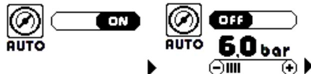
La modalité par défaut d'usine est AUTO ON qui permet au générateur de conserver constante et à la valeur optimale la pression de travail de la torche, même avec des variations de pression d'entrée. Ce système configuré en modalité automatique permet en effet de n'effectuer aucun réglage de la pression, ce sera le générateur qui configurera la valeur correcte par rapport à la torche insérée et à l'usinage sélectionné.
