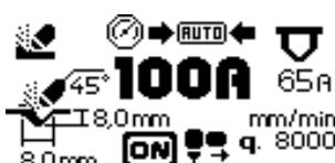
O gerador exibe automaticamente a largura e a profundidade do sulco que pode ser obtido com os valores de corrente (Fig. 4 Ref. G) à velocidade de trabalho relativa (Fig. 4 Ref. E) definidos pelo utilizador e indica o bico a utilizar (Fig.4 Ref. F) e a inclinação em graus à qual deve ser mantida a tocha durante o avanço.
