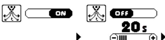
La modalidad por defecto de fábrica es AUTO ON, que permite que el generador regule automáticamente y sinérgicamente la duración del post gas en función de la antorcha activada, del valor de corriente configurado y del
