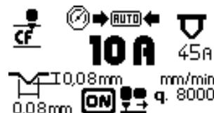
Il generatore visualizza automaticamente la larghezza e la profondità del solco ottenibile con i valori di corrente (Fig. 4 Rif. G) e velocità di lavorazione relativa (Fig. 4 Rif. E) impostate dall'operatore e indica l'ugello da utilizzare (Fig.4 Rif.F).
