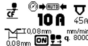
Le générateur affichera automatiquement la largeur et la profondeur du sillon pouvant être obtenu avec les valeurs de courant (Fig. 4 Réf. G) et la vitesse d'usinage correspondante (Fig. 4 Réf. E) configurées par l'opérateur et indique la buse à utiliser (Fig. 4 Réf. F).
