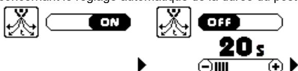
La modalité par défaut d'usine est AUTO ON qui permet au générateur de régler automatiquement et de manière synergique la durée du post gaz par rapport à la torche
