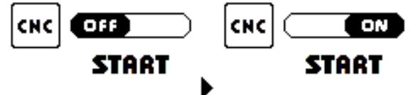
En configurant cette fonction sur ON on active la modalité de START depuis CNC correspondant aux pins 3 et 4 du connecteur AMP placé à l'arrière du générateur et on désactive en même temps le start manuel placé sur l'adaptateur frontal de la machine.
