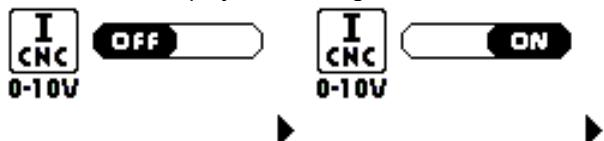
La modalidad predeterminada de fábrica es OFF, lo que implica que no hay ninguna posibilidad de regulación de la corriente de corte desde remoto entre el pin 1 (0V) y el pin 2 (10V).
