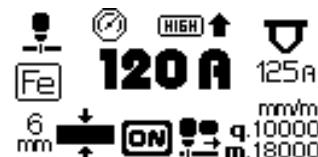
De todas maneras, es posible configurar la función en OFF para poder leer y regular la presión de trabajo de la antorcha en el valor deseado (dentro de ciertos límites preconfigurados), directamente desde el panel principal, que aparecerá de la manera siguiente:
