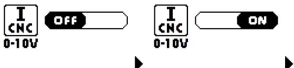
La modalità default di fabbrica è OFF il che comporta che non via sia alcuna possibilità di regolazione della corrente di taglio da remoto tra il pin 1 (0V) e il pin 2 (10V).
