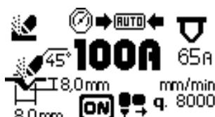
Il generatore visualizza automaticamente la larghezza e la profondità del solco ottenibile con i valori di corrente (Fig. 4 Rif. G) alla velocità di lavorazione relativa (Fig. 4 Rif. E) impostate dall'operatore e indica l'ugello da utilizzare (Fig.4 Rif.F) e l'inclinazione in gradi alla quale deve essere mantenuta la torcia durante l'avanzamento.
