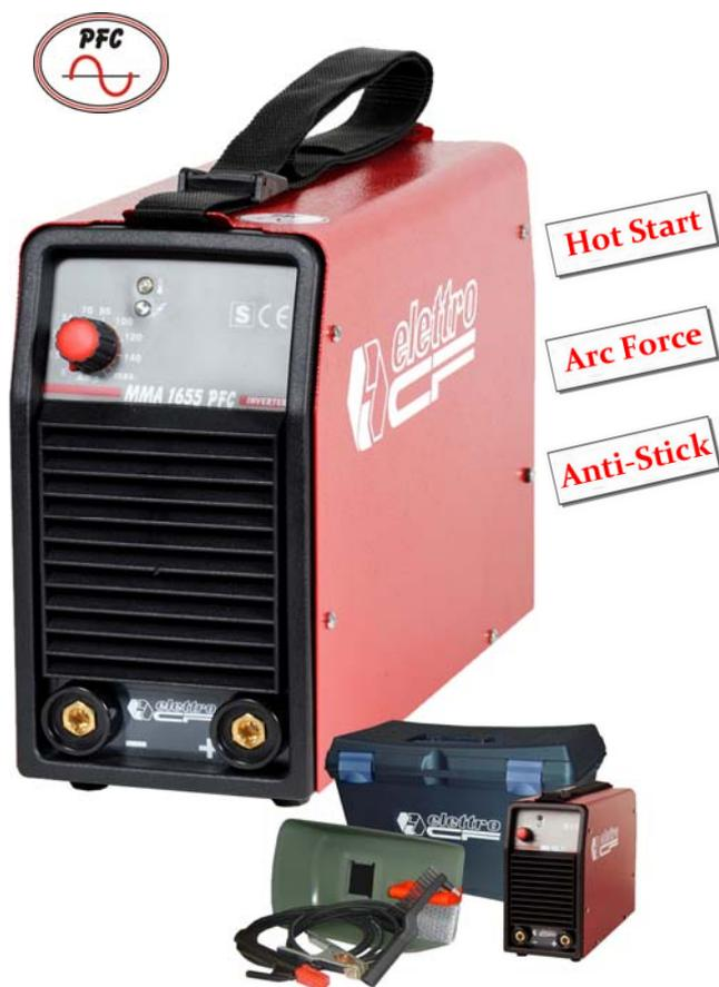
Questo generatore portatile ad INVERTER è stato progettato per interventi di manutenzione e montaggi di impianti esterni. Può funzionare anche con alimentazione domestica oppure azionato da motogeneratori con dispositivo di regolazione elettronico della tensione (non superiore ai 260V RMS) e una potenza uguale o superiore a 5 kVA.
