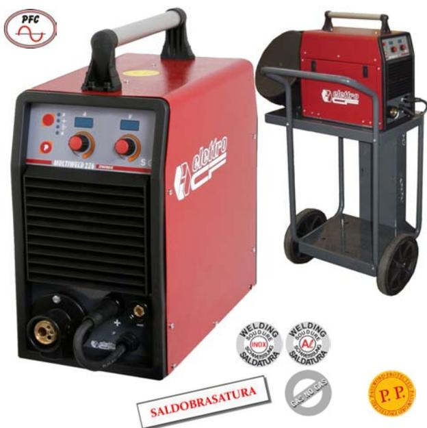
**MULTIWELD 236 SYNERGIC** è un generatore **inverter monofase multifunzione** in grado di saldare **alternativamente in MIG/MAG, MMA e TIG DC (con innesco lift)**. E' **compatto e leggero** e, con una **corrente di saldatura di 220A**, offre la possibilità di saldare fili di diametro fino a 1,2 mm. Può essere **alimentato da motogeneratori**.
