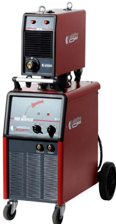
Gerador trifásico para soldadura MIG-MAG. Permite soldar aço, aço inox e alumínio.
