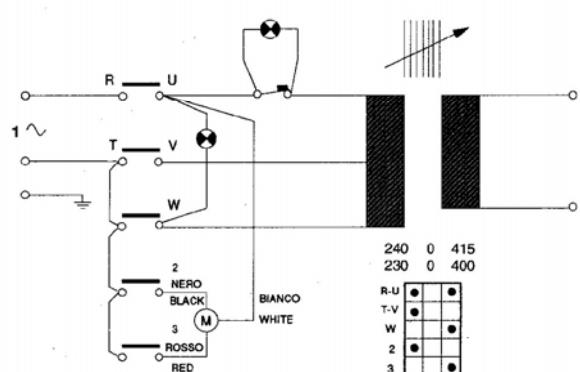
Due tensioni di alimentazione con ventilazione
