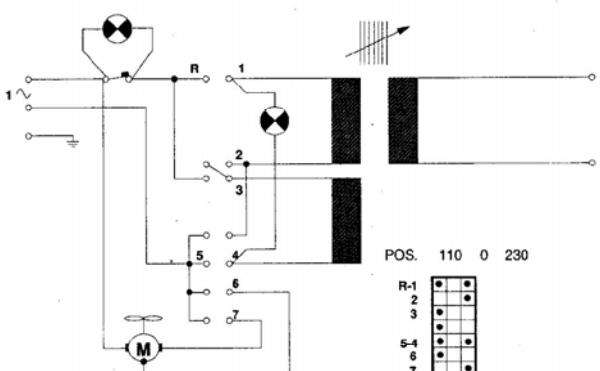
Collegamento serie-parallelo con ventilazione
