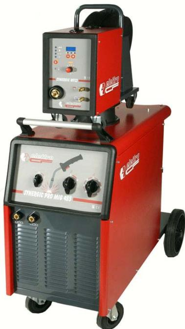
Dreiphas-Schweißstromquelle zum MIG-MAG-Endlosdrahtschweißen von Stahl, rostfreiem Stahl und Aluminium. Sie kann mit den **Drahtvorschubgeräten für 2 oder 4 Rollen**, Typ **WF20 oder WF40**, und mit dem synergetischen **Drahtvorschubgerät 4 Rollen**, Typ **WF44**, verwendet wird. Möglichkeit zum Anschluss 5 – oder 10-m Verlängerungskabeln zur Verbindung zwischen Drahtvorschubgerät und Schweißstromquelle. Schweißstromquelle vorbereitet für Wasserkühlung.
