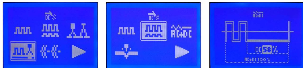
La linea **EVOLUTION TIG** utilizza una nuova interfaccia grafica display auto adattativa che semplifica le impostazioni della saldatura mostrando all'operatore solamente le funzioni e le caratteristiche della tipologia di saldatura selezionata, coniugando le funzioni speciali e automatiche di saldatura in corrente continua, alternata, pulsata e doppio pulsata per adattarsi al meglio a tutte le applicazioni che si possano presentare all'operatore.
